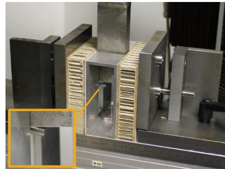
Abb. 3: Bodenträger-Prüfvorrichtung für Sandwichplatten
